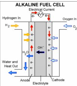
Anode Reaction:  $2H2 + 4OH^{-}$   $H2O + 4e^{-}$ Cathode Reaction:  $O_2 + 2H2O + 4e^{-}$   $4OH^{-}$
